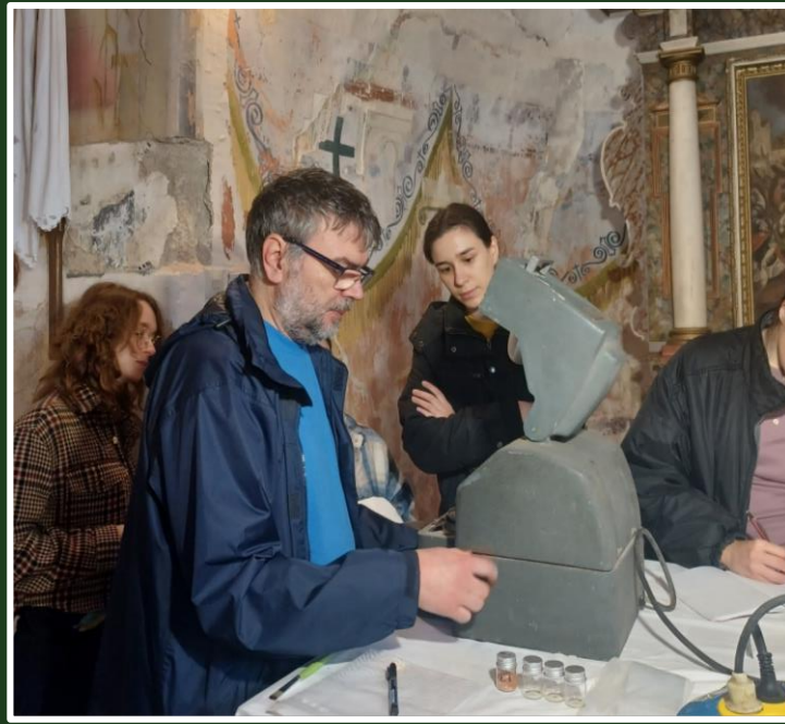
Sl. 8. Mjerenje vlage uzoraka vagon s infracrvenom grijalicom.
