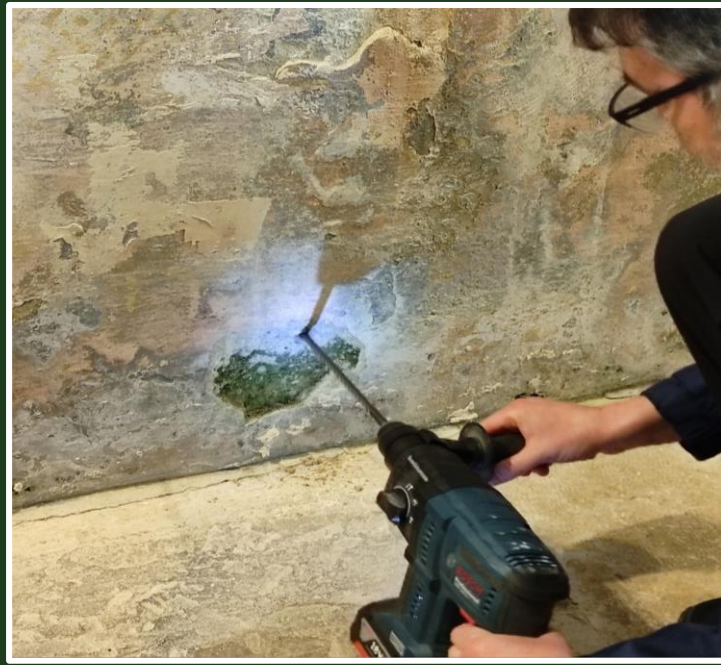
Sl. 7. Uzimanje uzorka za mjerenje sadržaja vlage u zidu.
